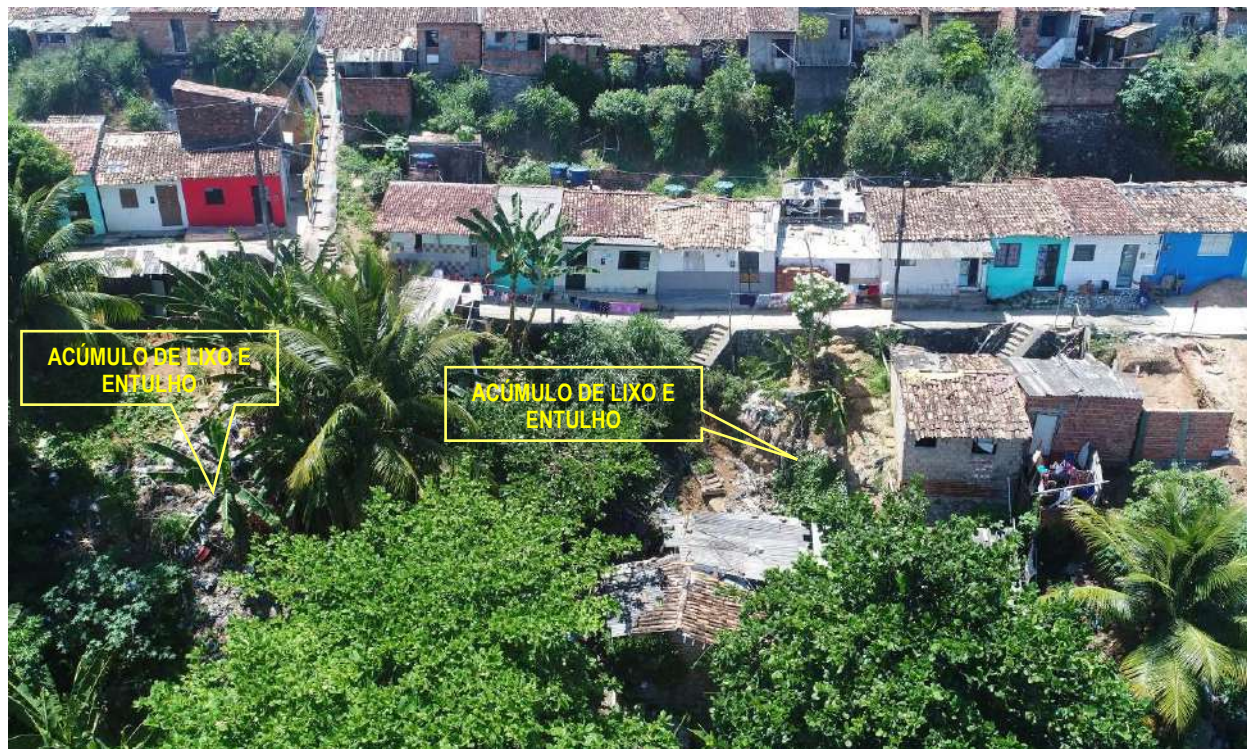
Figura 5.1.- Vista aérea do talude a ser estabilizado, observa-se o acúmulo de lixo e entulho presente no talude.
